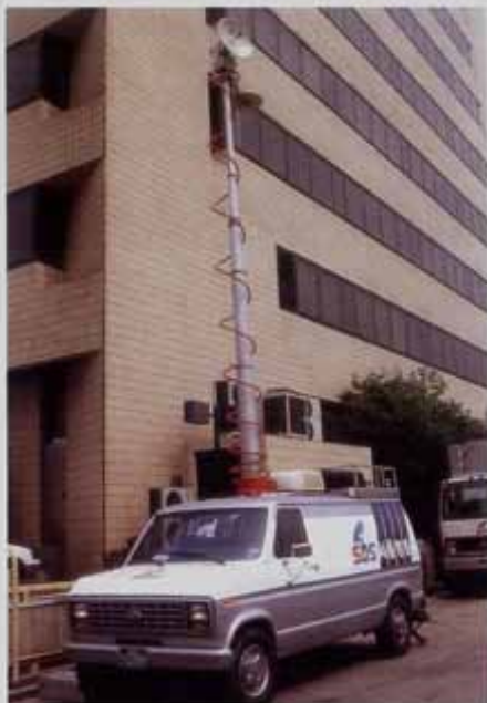
12미터까지 올라갈 수 있는 마이크로 웨이브까지 부착하여 다른 방송사보다 훨씬 안정된 생방송을 할 수 있는 뉴스전용 중계차의 모습이다. 앞으로의 전국방송 시대를 대비해 SBS는 '제값'을 할 수 있는 방송장비 구비에 더욱 박차를 가할 작정이다.
